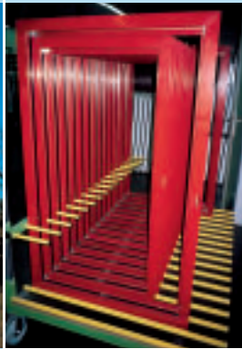
Neben den farblichen Gestaltungsmöglichkeiten bietet die Pulverbeschichtung vor allem Schutz vor Witterungseinflüssen. © Aluminium-Fenster-Institut
